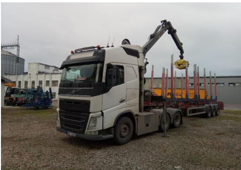
3.3. att. Specializēta puspiekabe atbilstoša lielgabarītu un smagsvaru pārvadājumiem mežsaimniecības produktiem
