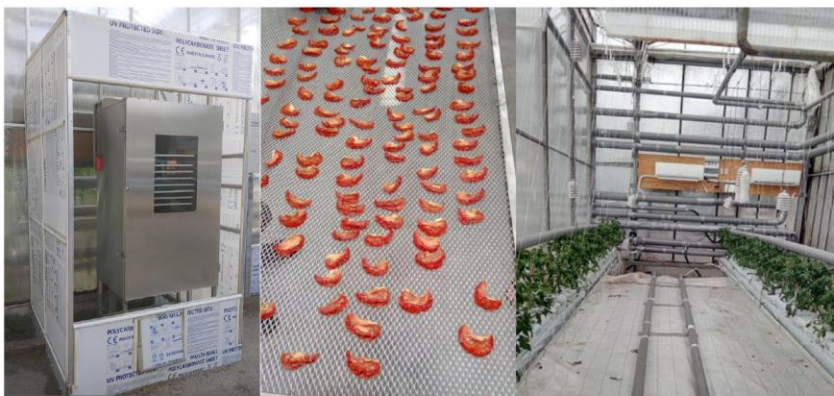
Žāvēšanas iekārta ar gaisa recirkulāciju un gatavā produkcija
