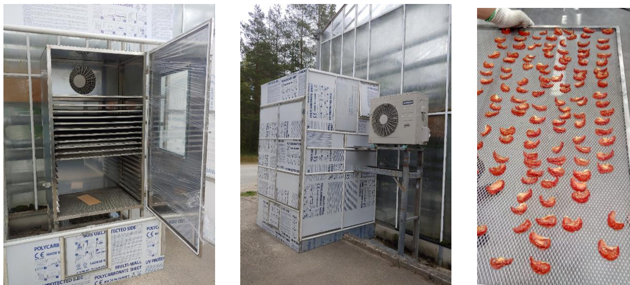
7.16. att. Biomosas žāvēšanas iekārta un gatavā produkcija
