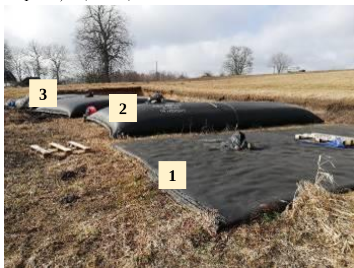
2.3. attēls. Ģeotekstila maiši ar sapropeli pēc I (1), II (2) un III (3) ieguves tehnoloģijām.
