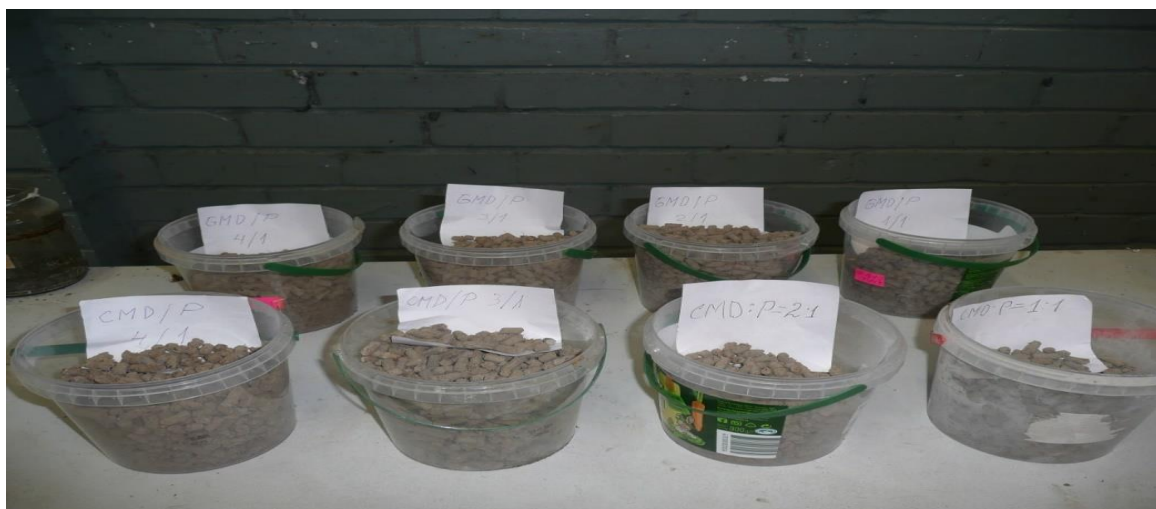
72. attēls. Pārbaudei sagatavotās maisījumu granulas.
