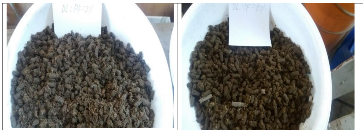
68. attēls. Svaigi izgatavotas granulas ir mīkstas un viegli drūp.
