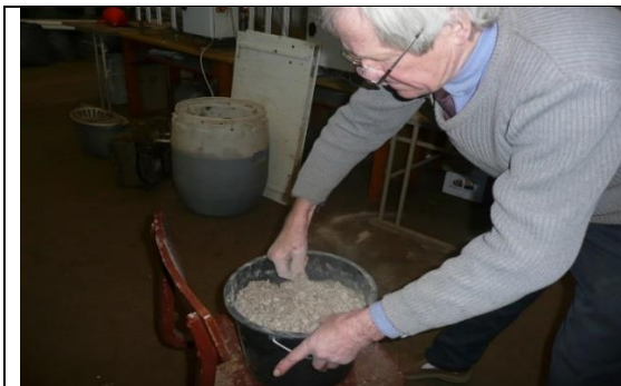
66. attēls. Digestāta un pelnu maisījums pirms granulēšanas.
