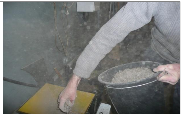
67. attēls. Maisījuma pildīšana granulatorā.
