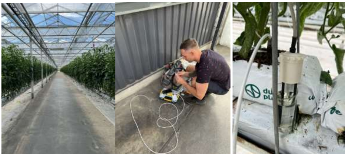
5.23. attēls. Sensoru pievienošana esošajam interneta tīklam un augsnes mitruma sensora kalibrēšana
