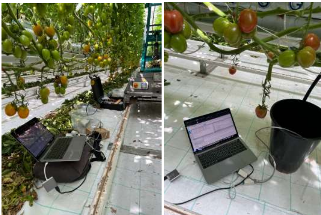
5.12. attēls. Sensoru pievienošana interneta tīklam un augsnes mitruma sensora kalibrēšana
