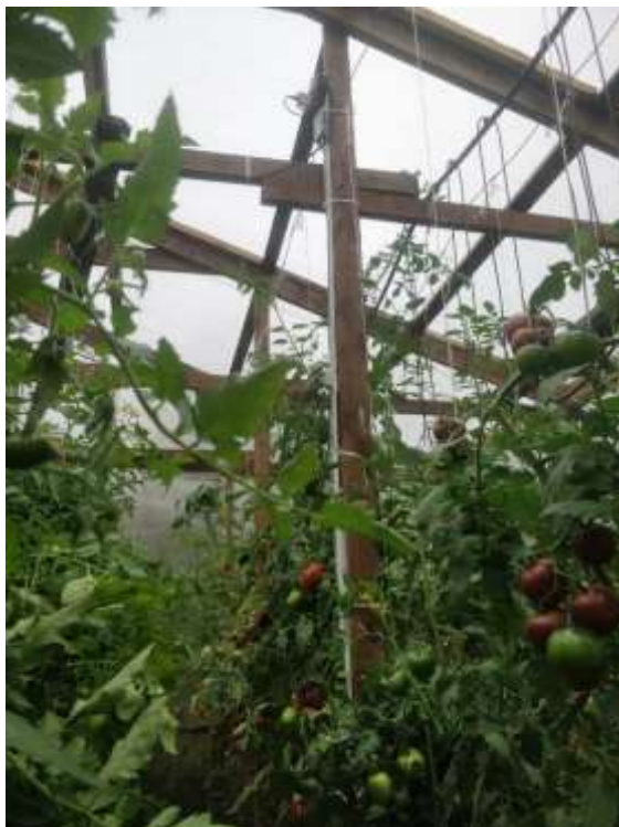
5.30. attēls. Uztādītais gaisa temperatūras, mitruma, CO2 un augsnes temperatūras sensoru stabs.
