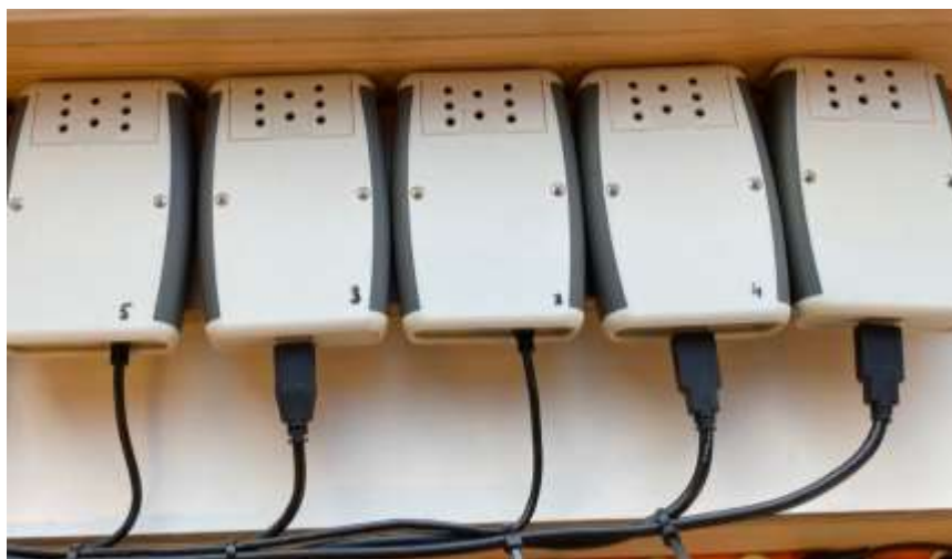
Attēls 2.43. CO2 sensora un mikrokontroliera kopēja korpuss attēls
