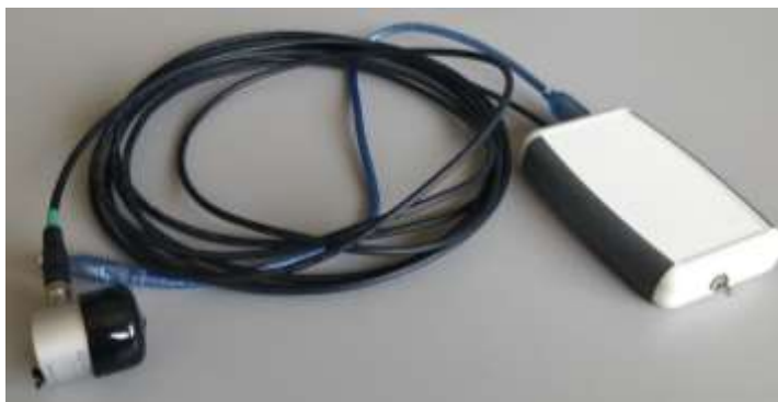
Att. 2.78. Izstrādātais portatīvais PAR sensora modulis
