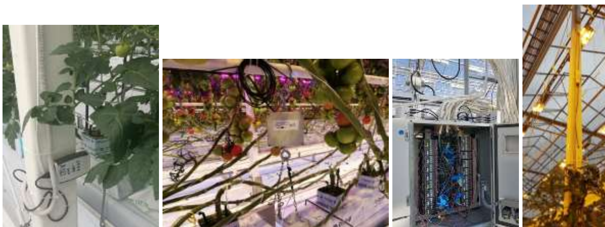
Attēls 2.2. uMOL balstītie un pēcāk IRIS projektā uzlabotie IoT sensoru sistēmas mitruma, temperatūras, svara un elektroenerģijas patēriņa monitoringa sensori.
