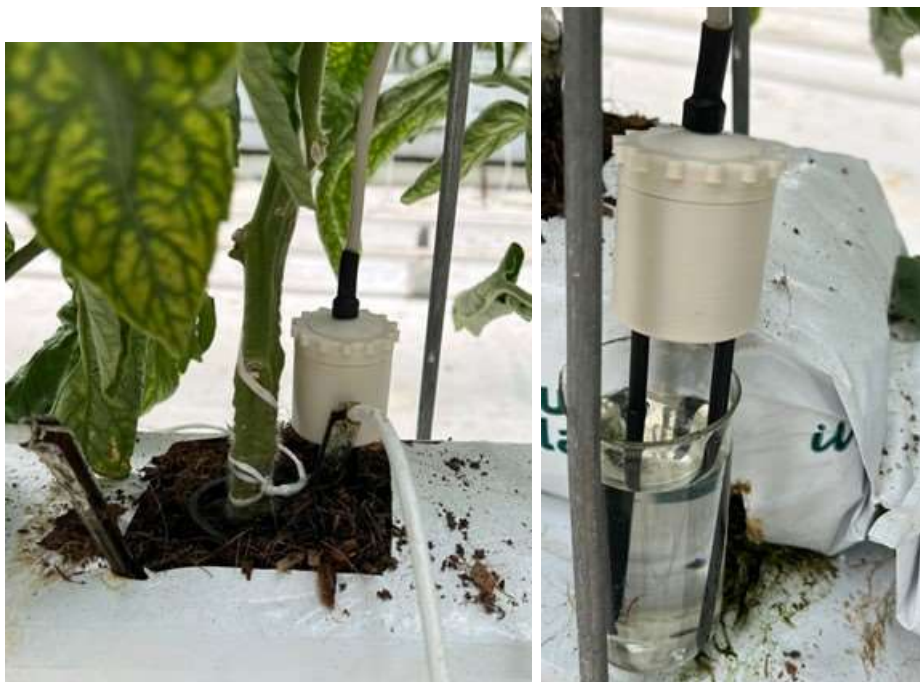
Attēls 2.45. Augsnes mitruma sensora ārējais izskats.
