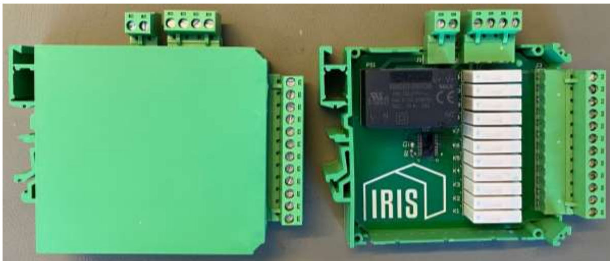
Attēls 2.46. Releju moduļa ārējais izskats.
