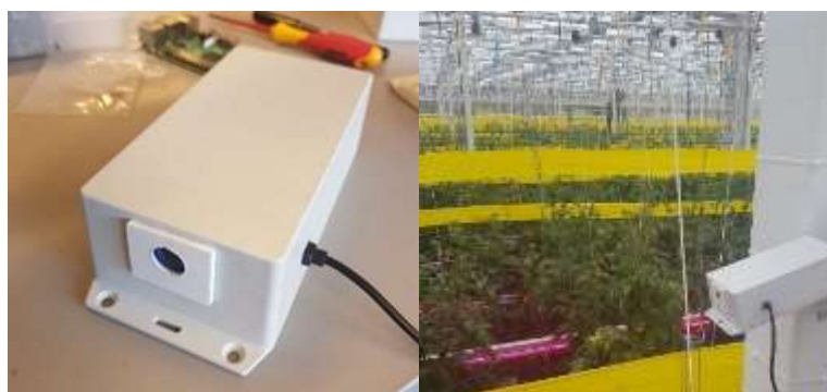
Attēls 2.47. SI-NDVI sensora izskats un izmantošanas piemērs
