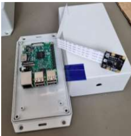
Attēls 2.50. Raspberry Pi platformas un NoIR kameras ārējais izskats.
