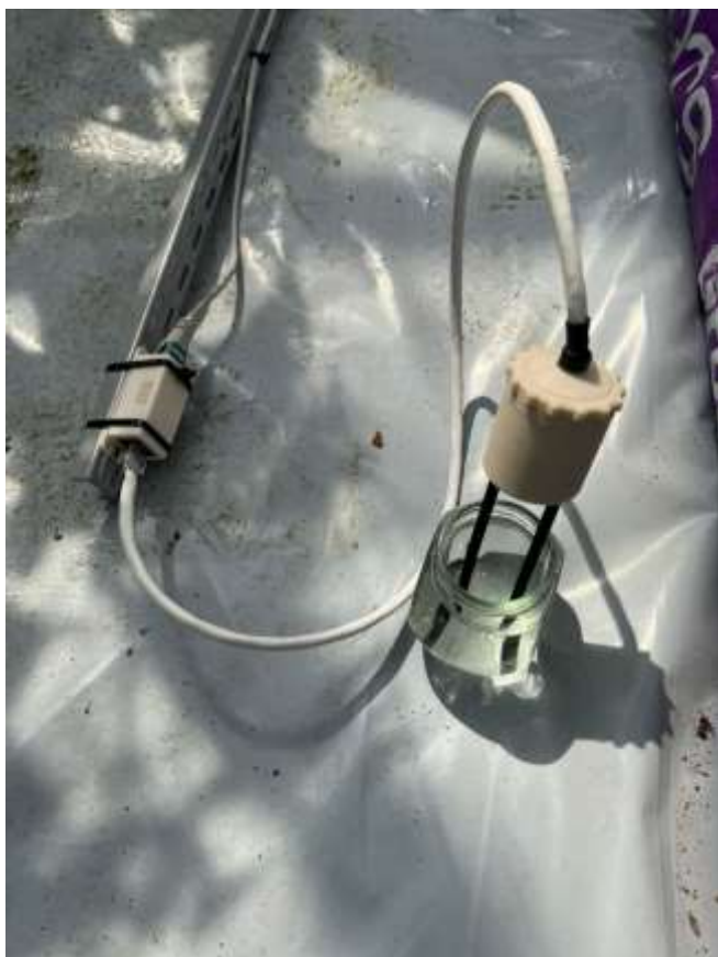
5.15. attēls. Augsnes mitruma sensora kalibrēšana
