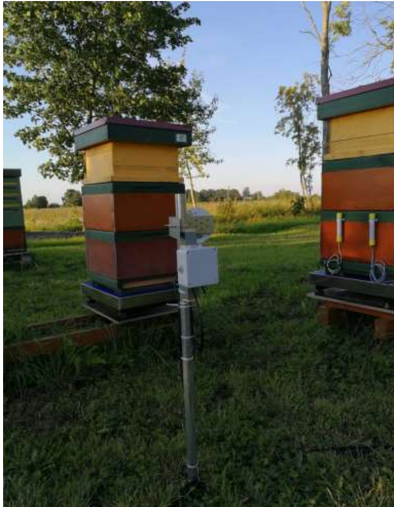
5. attēls: Kameron un sensoru izvietošana un stiprināšana, pamati un svaru platformas līmeņošana.
