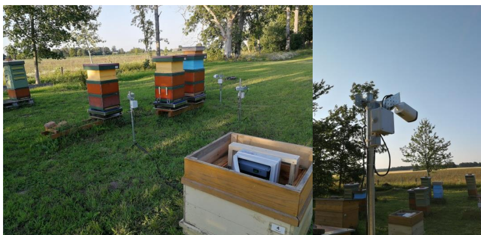
3. att. Attālināta bišu saimju monitoringa sistēma ar videonovērošanu Talsu novada Lubes pagastā.
