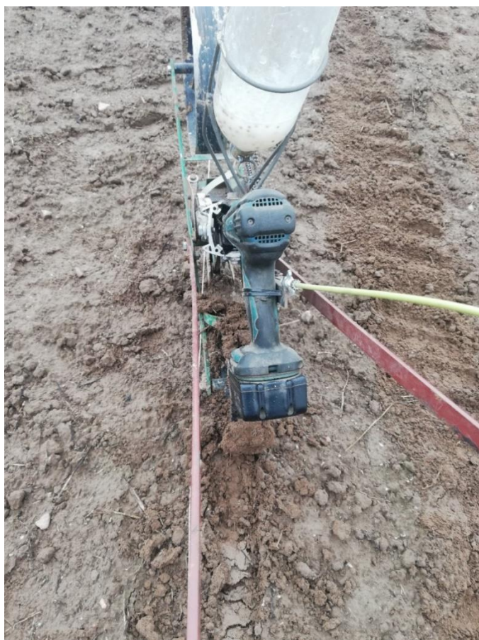
46. attēls. Šķidro kapsulu sēja ar sējmašīnas prototipu.
