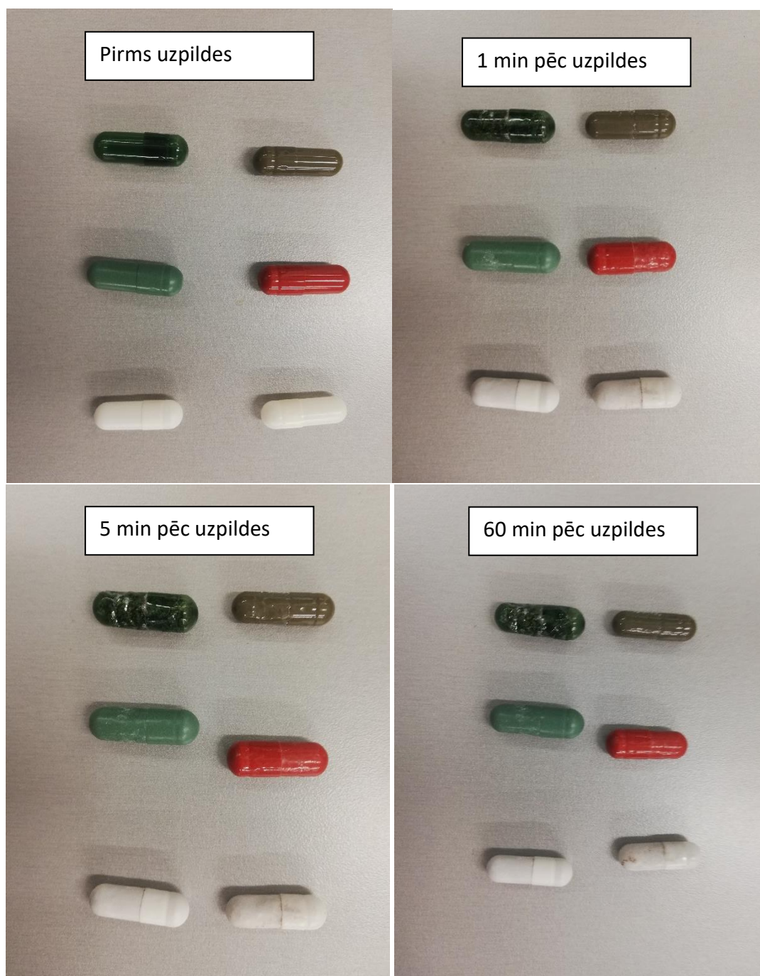
18. attēls. Dažāda veida kapsulu sadalīšanās 1, 5 10 un 60 minūtes pēc uzpildes ar augsnes, māla un vermikulīta maisījumu, kam pievienots 10% ūdens. .
