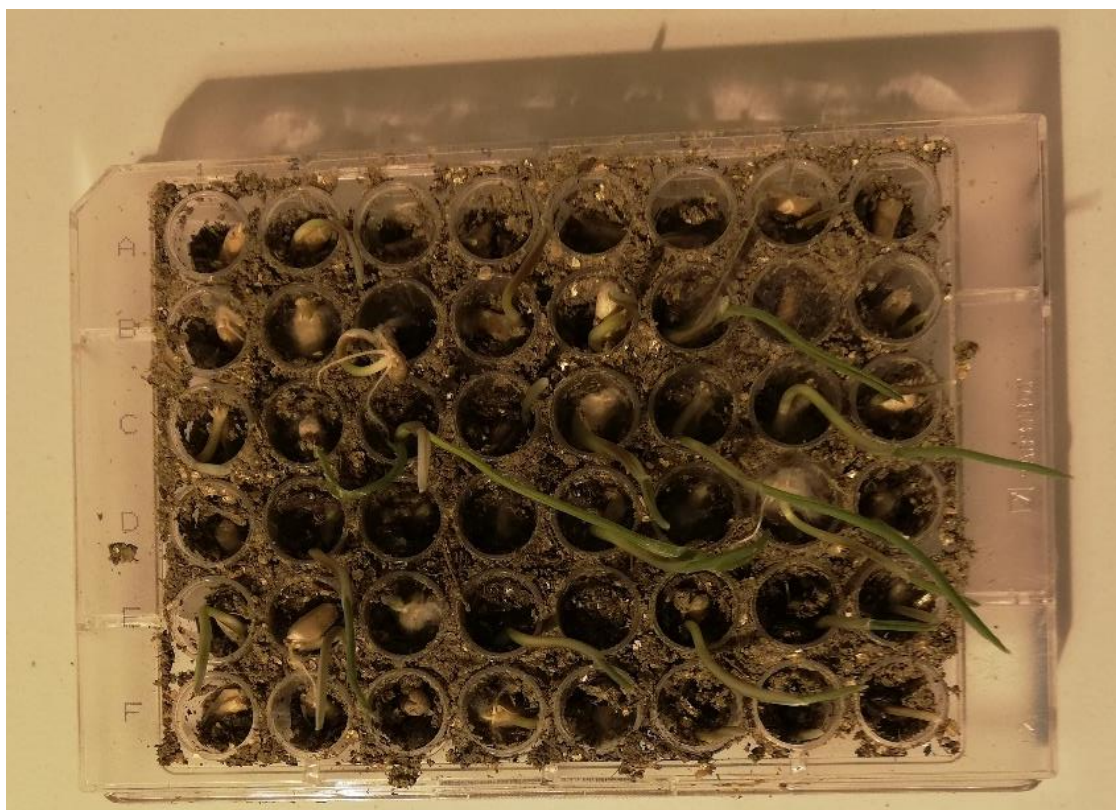
15. attēls. Triticāles sadīgšana septītajā dienā pēc dīgšanas uzsākšanas substrātā ar 70:20:10 augsne : māls: vermikulīts ar 10% ūdens saturu.
