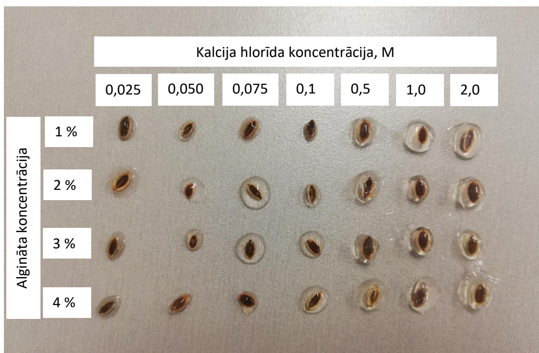
20.attēls. Kalcija hlorīda un algināta koncentrācijas ietekme uz algināta lodīšu izveidošanos, kapsulas veidojot “no iekšpuses uz āru”.
