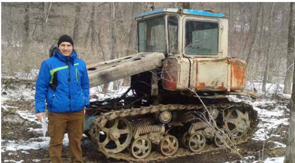
Kokmateriālu vilkšanai pēc stumbra metodes izmantotā tehnika – "DT 75"
