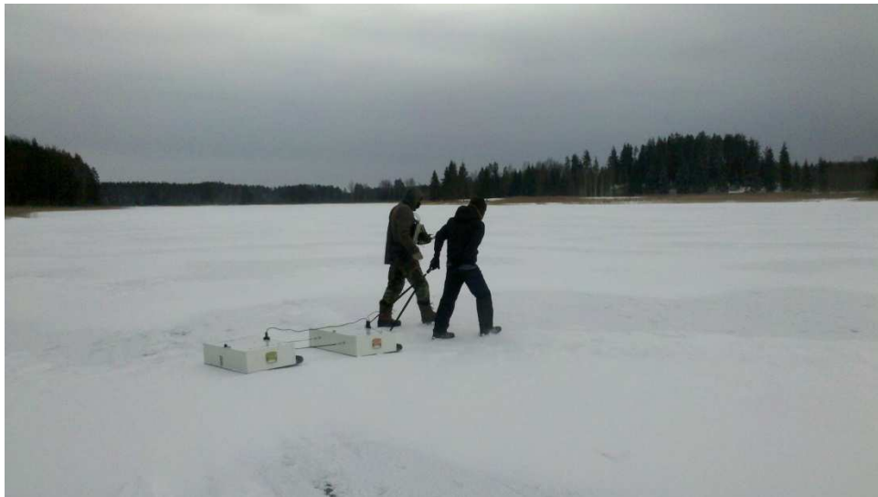
Mērījumi, izmantojot 38 MHz antenu sistēmu.
