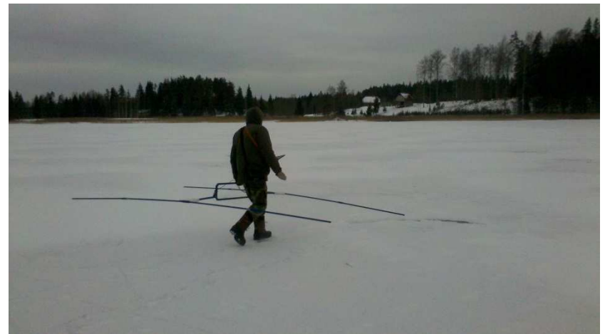
Mērījumi, izmantojot 38 MHz antenu sistēmu.
