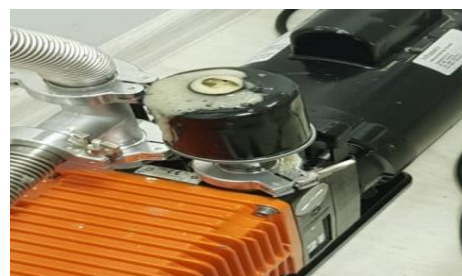
Vakuums, šķidrums tiek „ierauts” kompresorā
