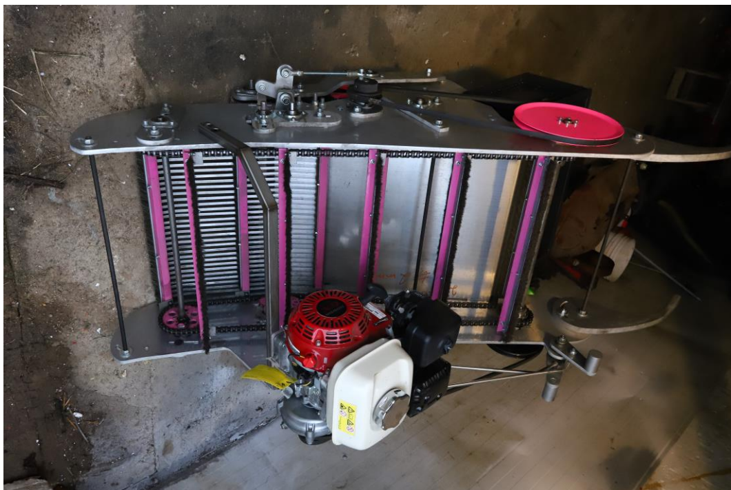
3. Attēls. Paaugstinātas veiktspējas dzērveņu novākšanas kombaina eksperimentālais makets*.
