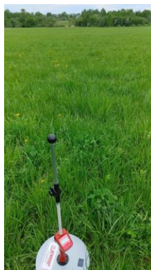
11. att. Ekspresmetode biomasas ražas uzskaitēi ganībās ar elektronisko ierīci Platometer .
