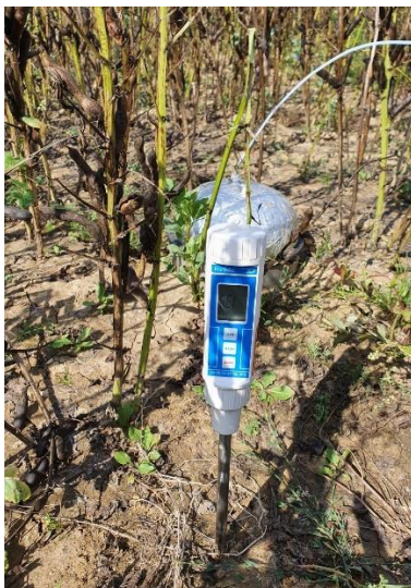
5.3. att. Augsnes mitruma mērītājs (autors: J.Pilecka).
