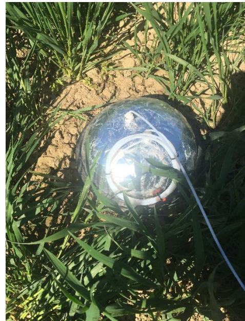
5.2. att. Kamera gāzu mērījumu veikšanai (autors: I.Grünfelde).
