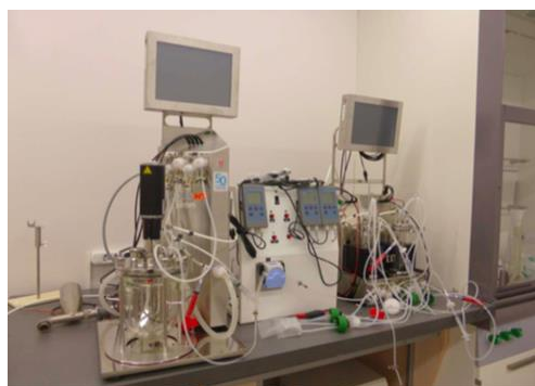
11. att. Kuņģa-zarnu trakta simulācijas iekārta paredzēta uzturvielu noārdīšanās procesu izpētei, funkcionālo un klasisko pārtikas produktu sagremojamības izpētei.
