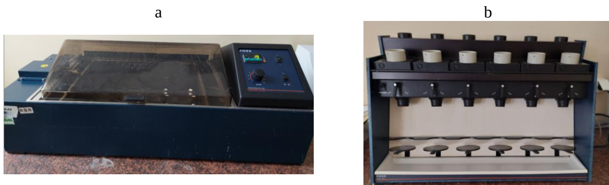
8. att. Kopējo šķiedrvielu noteikšanai izmantotās iekārtas: ūdens vanna (a) un filtrēšanas iekārta (b).
