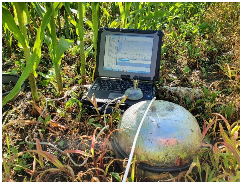
3.7.6. attēls. Diver DI 500, Eijkelkamp barometriskā spiediena mērītājs, datu nolasīšanas iekārta un gāzu mērījumu kamera (autors: J.Pilecka)
