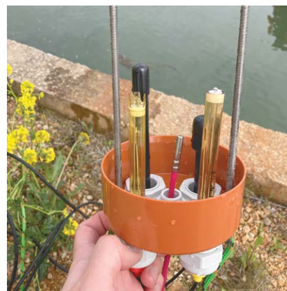
Ūdens kvalitātes devēji tiek novietoti aizsargapvalkā
