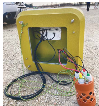
Devēju mezglos ir paredzēts nodalījums ūdens kvalitātes devēju ērtai transportēšanai
