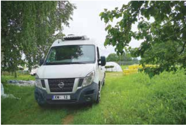
Mikroautobuss ar dzesēšanas aprīkojumu, kas paredzēts ogu atdzesēšanai un pārvadāšanai
